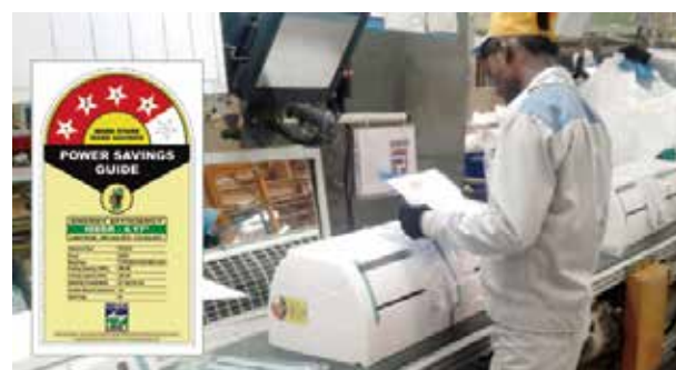
インバータ機を適正に評価する指標に基づいた新しいエネルギーラベルが貼付されたエアコン
