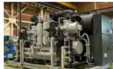
高効率冷凍機 (前川製作所)
