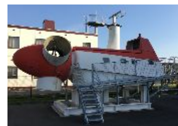
Actual 900-kW wind turbine
