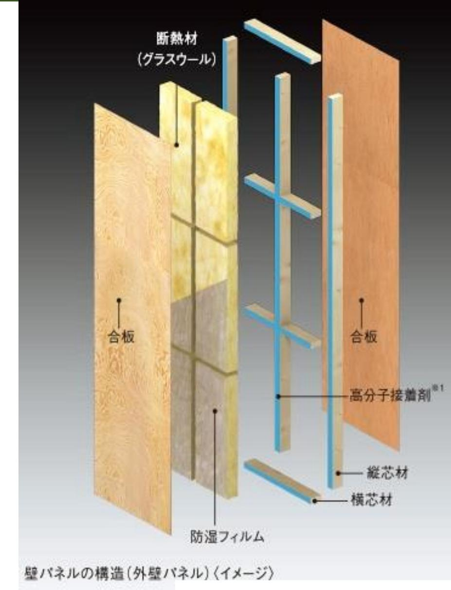
壁パネルの構造(外壁パネル)〈イメージ〉
