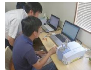
実体顕微鏡を用いたマイクロプラスチックのFT-IRを使用する物質特定選別と撮影
