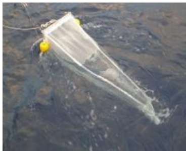
ニューストンネットを用いたネットを用いた浮遊マイクロプラスチックの回収
