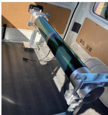
＜ポールに巻き付けたペロブスカイト型太陽電池＞
