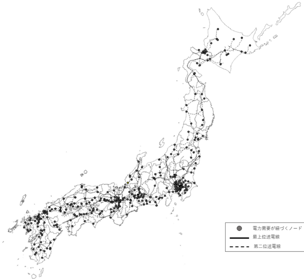
図 1 本分析における地域間連系及び地内基幹送電線概要図(沖縄地域を除く)
