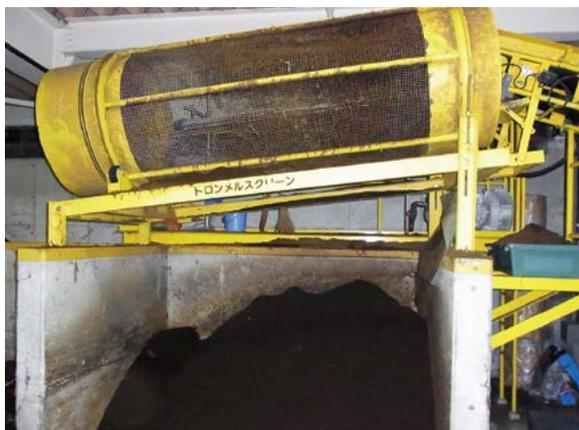
図28 発酵プロセス後に汚染物質を除去するトロンメル（池田町）
