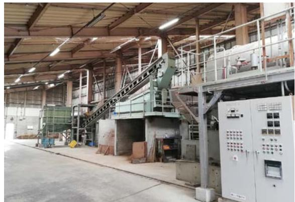
図27 発酵プロセス後の機械的選別(長井市)
