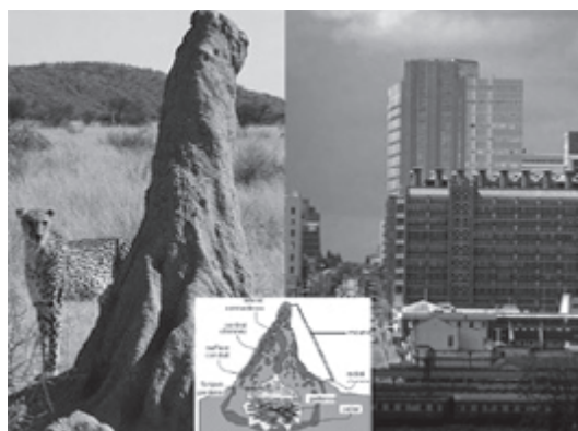
ジンバブエ・ハラレの省エネビル： シロアリの巣型の空調システム (by ZERI)
