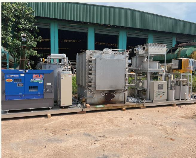
▲ 実証実験を進める廃プラスチックの油化装置
