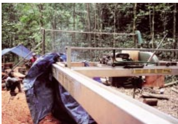
ポータブル製材用ノコギリで 認証材を製造 (パプアニューギニア)
