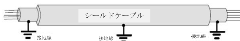
図 3 信号線接地概念図
