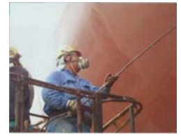
室外涂装作业 (船坞内)
