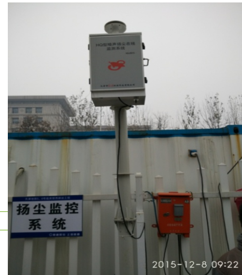
施工現場での巻上粉塵オンライン モニタリングシステム
