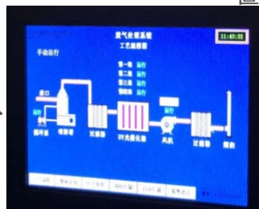
光触媒及び後部活性炭吸着装置
